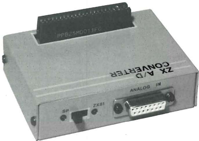
Il deviatore SP/ZX81 va posizionato in funzione del tipo di ZX usato dal connettore a 15 poli visibili sulla destra, fanno capo gli ingressi analogici.
